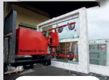
Be- und Entladen von Hebeschiebeelementen
