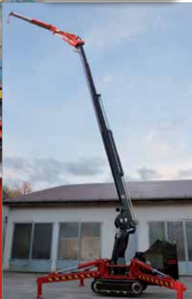
Kran mit Jib (Kranausleger)
